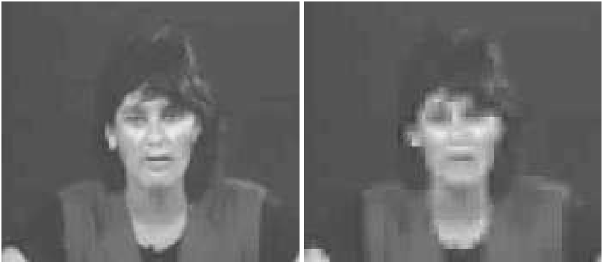
FIG. 5.5 - Image encodée avec TCD 4 \times 4 et une TCD 2 \times 2
